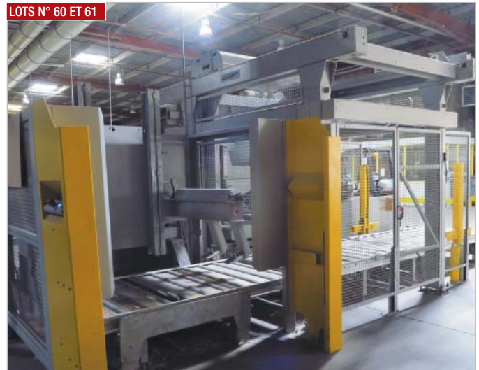
► Compteur empileur MULLER MARTINI, mod. AVANTI PLUS, type 0443.400 (2006) avec palettiseur en sortie ► MULLER MARTINI counter/stacker, AVANTI PLUS model, type 0443.400 (2006) with palletiser on exit
