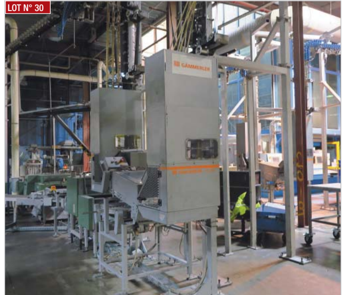
► Convoyeur aérien GÄMMERLER pour revue comprenant 2 rouleaux presseurs PS300 et 8 postes de descente FS260 ► GÄMMERLER overhead conveyor for review comprising 2 PS300 pressure rollers and 8 FS260 lowering stations
