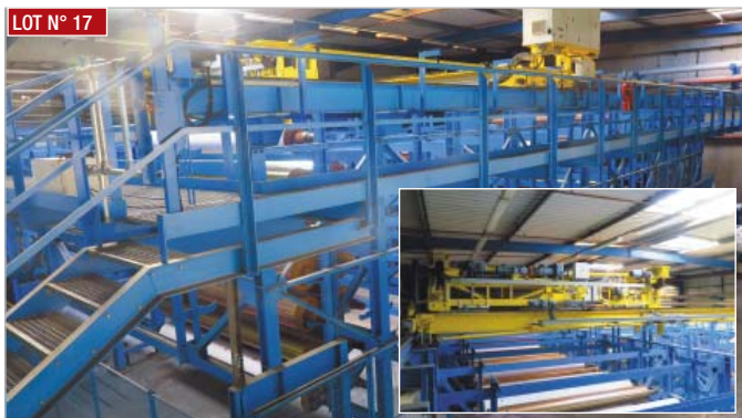
► Magasin pour stockage des cylindres comprenant 48 supports d'une capacité de 7 à 15 cylindres chacun avec pince de préhension, convoyeur et armoire de commande ► Store for cylinder storage comprising 48 supports with a capacity of 7 to 15 cylinders each depending on the diameters with gripper, conveyor and control cabinet
