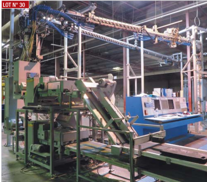
► Convoyeur aérien GÄMMERLER pour revue comprenant 2 rouleaux presseurs PS300 et 8 postes de descente FS260 ► GÄMMERLER overhead conveyor for review comprising 2 PS300 pressure rollers and 8 FS260 lowering stations
