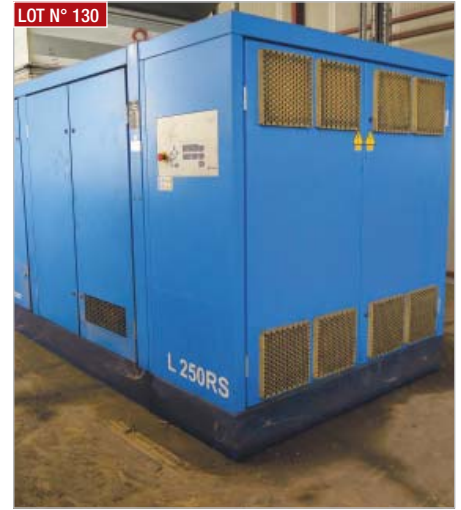
► Compresseur COMPAIR, type L 250RS - 7,5A, N° 349031/0600, poids 4910 kg, volume 41,4 m³, pression 7,5 bar, puissance moteur 250 kW ► COMPAIR compressor L 250RS - 7,5A, N° 349031/0600, weight 4910 kg, vol. 41,4 m³, pressure 7,5 bar, power 250 kW
