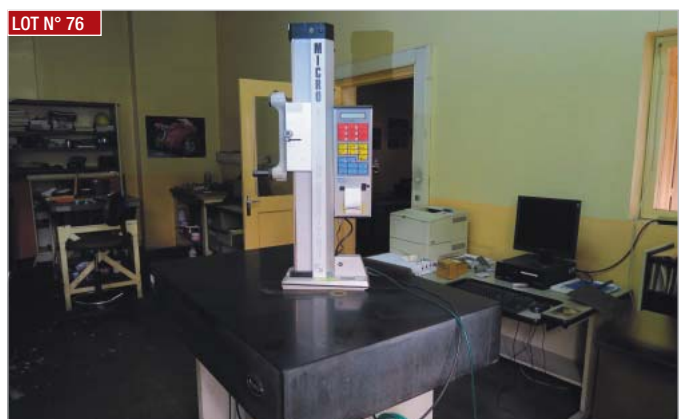
▶ Colonne de mesure MICRO VERTEX, MV500 , série n° 591-403-326, précision de lecture 0,01 mm et 1 marbre granit 1200 X 1000 sur selette métal, affichage digital sur les 3 axes (X-Y-Z) ▶ MICRO VERTEX Measuring column, MV500, serial no. 591-403-326, reading accuracy 0.01 mm and 1 granite marble surface 1200 X 1000 on metal base, digital display on all 3 axes (X-Y-Z)
