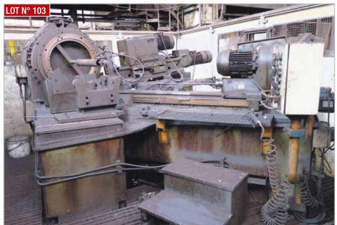
▶ Perceuse Hyperboloïde PM , machine spéciale pour perçage des chemises, 2 broches de forage ▶ Hyperboloid PM drilling machine, special machine for drilling liners, 2 drilling spindles
