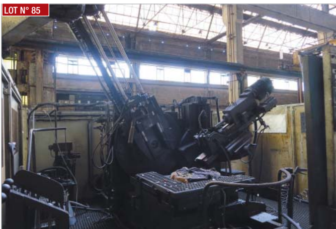
▶ Perceuse hyperboloïde PM , machine spéciale pour perçage des chemises, 2 têtes de forage, CN NUM ▶ PM hyperboloid drilling machine, special machine for drilling liners, 2 drilling heads, NUM NC
