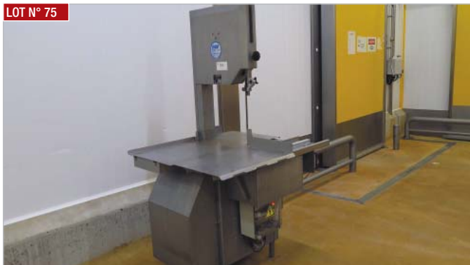
► Scie à os BIRO , type 3336 (2009), 2 vitesses de coupe, ht de coupe 406 mm, larg. de coupe 395 mm ► BIRO bone saw , type 3336 (2009), 2 cutting speeds, cutting height 406 mm, cutting width 395 mm
