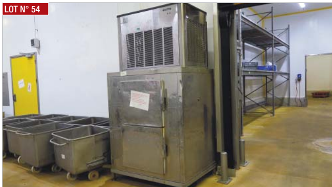
► Machine à glace SCOTSMAN , type MF66AS (2015), cap. 1220 kg/ jour ► SCOTSMAN ice machine , type MF66AS (2015), cap. 1220 kg/day
