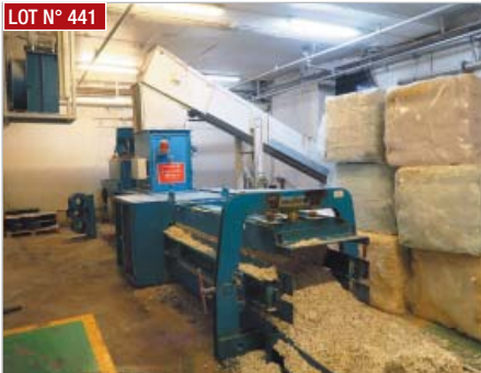
► Presse à balle PAAL , type PACO MAT 1-35, année 2009 ► PAAL bale press, type PACO MAT 1-35, year 2009
