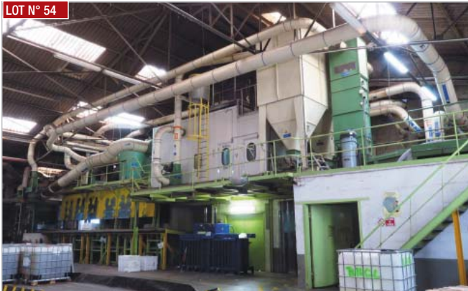
► Ligne ouvreuse LAROCHE comprenant : cheminée d'évacuation des matières contaminées, préfiltration, cabine de filtration, 3 pré - séparateurs, 2 séparateurs, 2 ventilateurs, 2 cyclones, 2 détecteurs de métaux, armoire de commande et plateforme métallique ► LAROCHE process comprising : chimney for the disposal of contaminated materials, pre-filtration unit, filtration cabin, 3 pre-separators, 2 separators, 2 fans, 2 cyclones, 2 metal detectors, contro cabinet and metal platform
