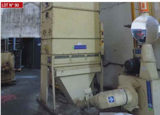
► Floconneuse LAROCHE, densifieur et trémie BIG SAF filtre fin ► LAROCHE flocking unit, densifier and hopper BIG SAF fine filter
