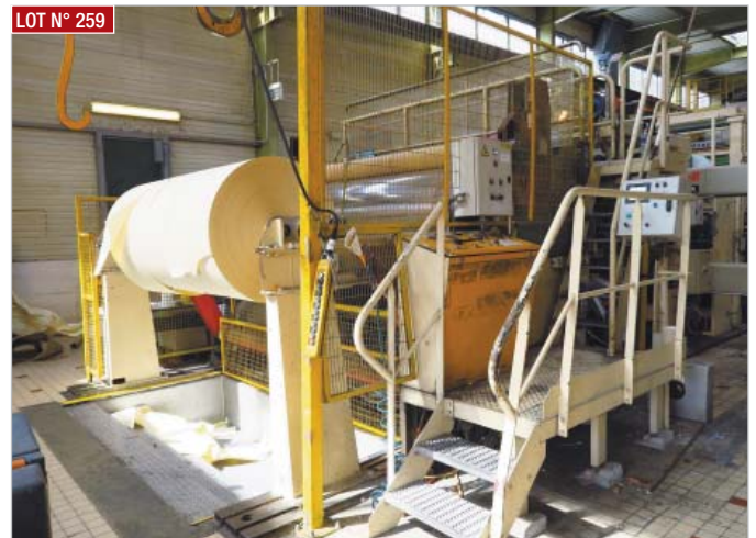
LOT N° 259 ► Enrouleuse pope, Ø 1000 mm, équipée d'un système de changement automatique de bobine (Turn Up). Fournisseur IBS ► POPE wrapping machine, Ø 1000 mm, equipped with an automatic reel change system (Turn Up). IBS supplier
