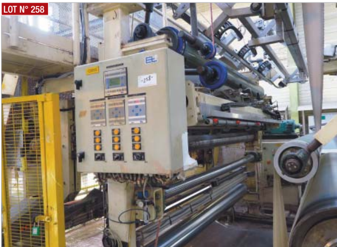
LOT N° 258 ► Refendeuse 3 couteaux : coupe de la bobine mère en 4 bobines filles. Fournisseur Erhardt Leimer ► 3 knife slitter: cutting of the mother reel into 4 daughter reels Supplier Erhardt Leimer
