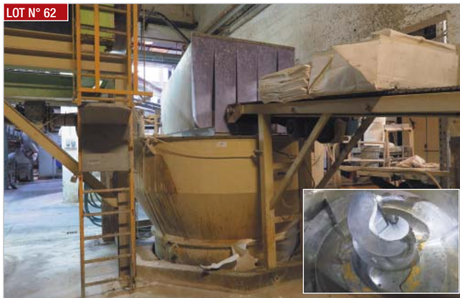
▶ Pulpeur hélicoïdal avec armoire de commande ▶ Helical pulper with control cabinet
