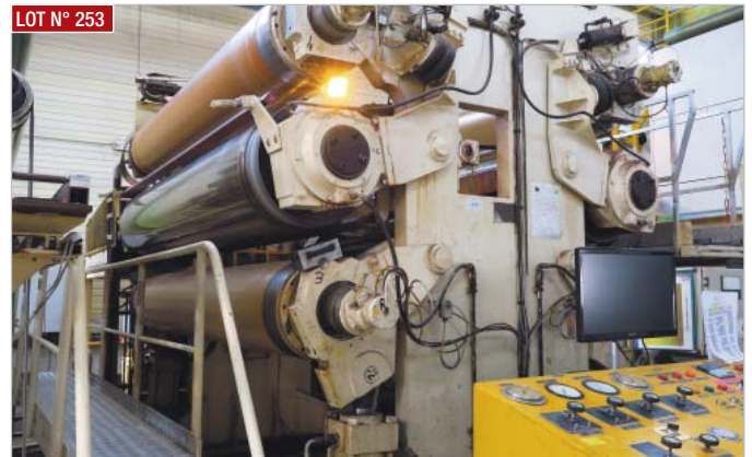
LOT N° 253 ► Presse de calendres composée de 2 lisses doubles : - Lisse 1 : Presse inférieure bombée variable Ø 485 mm, presse acier intermédiaire Ø 600 mm et presse supérieure bombée variable Ø 485 mm - Lisse 2 : Presse inférieure bombée variable Ø 485 mm, presse acier intermédiaire Ø 600 mm et presse supérieure bombée variable Ø 485 mm ► Calendar press composed of 2 double rails: - Loom 1 : Variable curved lower press Ø 485 mm, intermediate steel press Ø 600 mm and variable curved upper press Ø 485 mm - Loom 2 : Variable curved lower press Ø 485 mm, intermediate steel press Ø 600 mm and variable curved upper press Ø 485 mm
