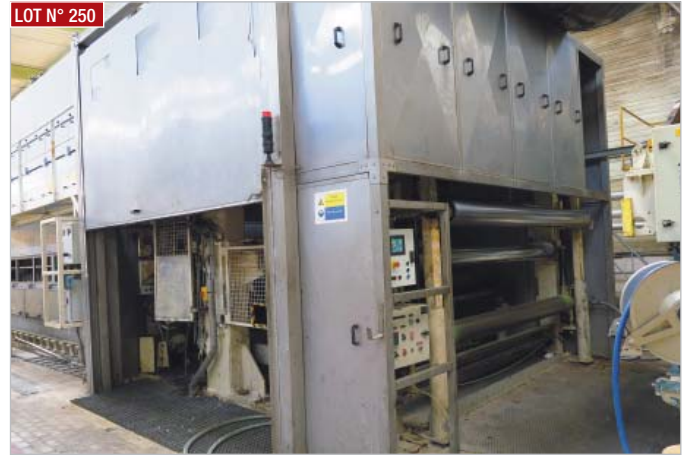
LOT N° 250 ► Imprégnatrice : Ø des presses 400 mm, 1 presse fixe et 1 mobile, 1 bac d'imprégnation mobile sur table élévatrice. Possibilité de travailler en mode size presse ► Impregnator: Ø of presses 400 mm, 1 fixed and 1 mobile press, 1 impregnation tank mobile on lifting table. Possibility to work in size press mode
