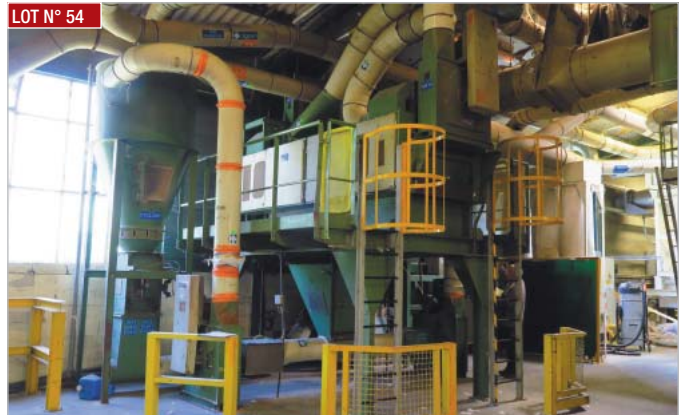
► Ligne ouvreuse LAROCHE comprenant : cheminée d'évacuation des matières contaminées, préfiltration, cabine de filtration, 3 pré - séparateurs, 2 séparateurs, 2 ventilateurs, 2 cyclones, 2 détecteurs de métaux, armoire de commande et plateforme métallique ► LAROCHE process comprising : chimney for the disposal of contaminated materials, pre-filtration unit, filtration cabin, 3 pre-separators, 2 separators, 2 fans, 2 cyclones, 2 metal detectors, contro cabinet and metal platform
