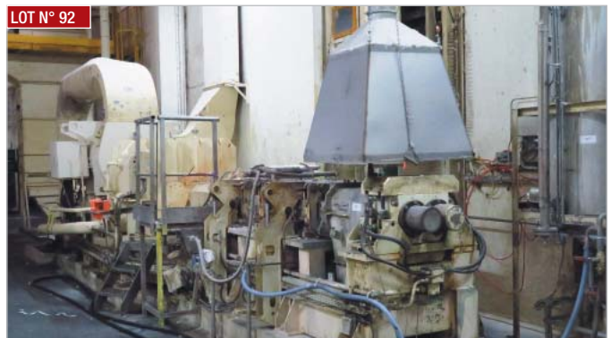
► Ligne d'arbre CLESTRAL bi-vis, type KRO/200, mod. BP10, année 1990 avec réducteur COMELOR, type 3PH807, année 1992 ► CLESTRAL twin screw shaft line, type KRO/200, mod. BP10, year 1990 with COMELOR reducer, type 3PH807, year 1992
