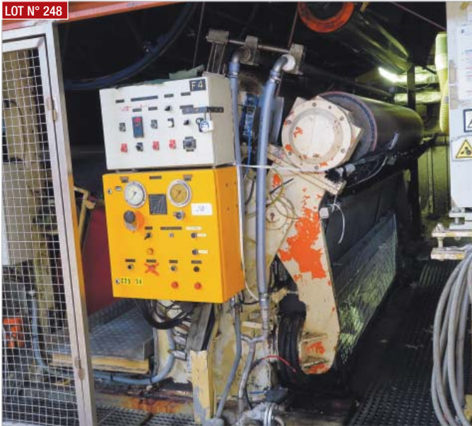
LOT N° 248 ► Size presses, Ø des presses 500 mm, une presse fixe et une mobile ► Size presses, Ø of presses 500 mm, 1 fixed and 1 mobile press
