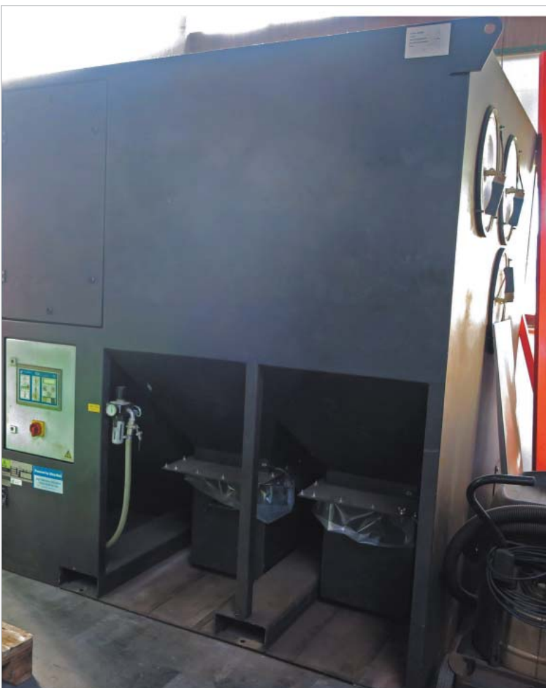
► Aspiration DONALDSON Type : Dfo 2-6 N° de série : 90053531A Année 2009 400 V, 50Hz, Poids machine 1325 kg
