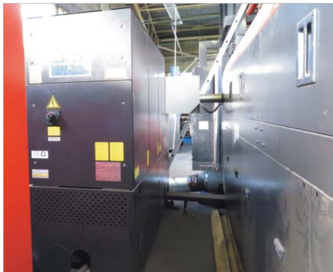
► Armoire électrique de la laser LC3015F1 Laser FANUC AF4000i-B type : A04B-0815-B332 N°de série : L08740745 220V 60 Hz 190 A 55 KVA Année 2008
