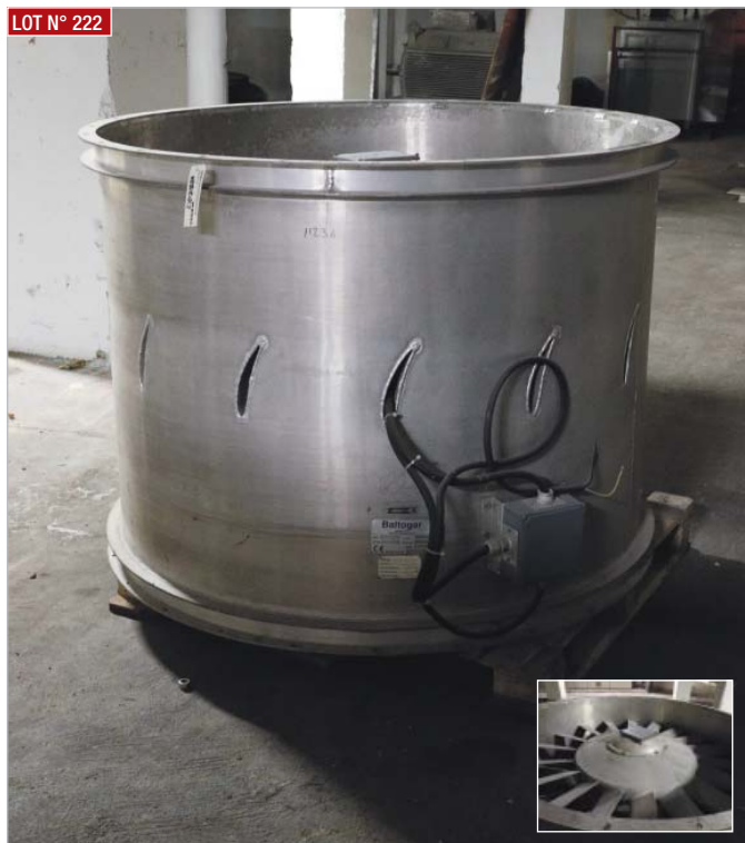
► Ventilateur BALTOGAR, mod.1300E01, puissance 7,5 kW ► BALTOGAR Fan, type1300E01, 7,5 kW
