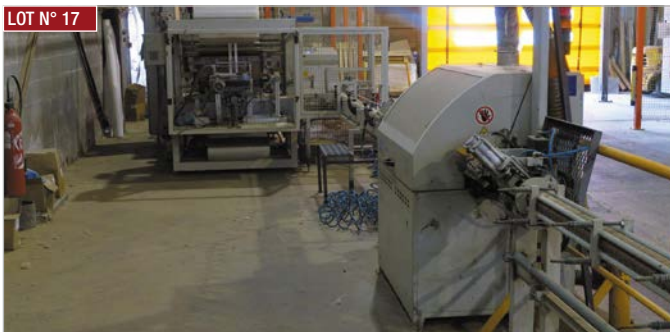
► Scie MOST, type MBC 100 (2011), contrôle de longueur et filmeuse et tunnel de rétractation ► MOST saw, type MBC 100 (2011), Length control, Wrapper and shrink tunnel
