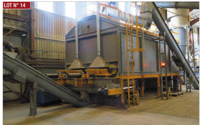
► Silo produit sec 60 m 3 avec vis de transfert ► Silo 60 m 3 with screw
